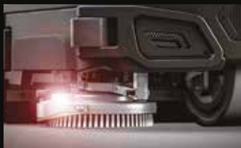
Spazzola laterale lavante (disponibile per le versioni a disco)
