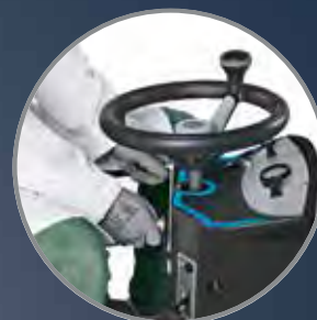
La movimentazione delle spazzole (centrale e laterale/i) avviene semplicemente tramite 2 leve
